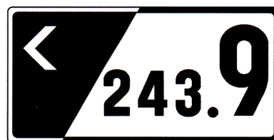
01b – Demarcação hectométrica da via – IC
