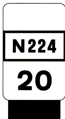
03d – Demarcação miriámetrica da via – restantes estradas
