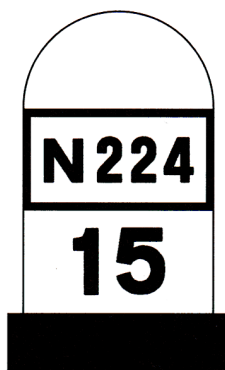
02d – Demarcação quilométrica da via – restantes estradas
