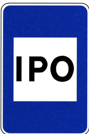
H34 – Centro de inspecções
