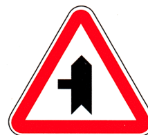
B9a – Entroncamento com via sem prioridade
