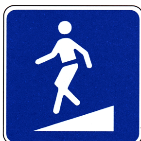
H8a – Passagem desnivelada para peões
