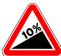
A3b – Subida de inclinação acentuada
