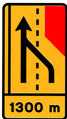
ST2 – Supressão de via de trânsito
