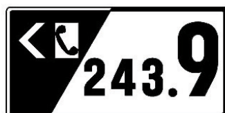
01b—Demarcação hectométrica da via — IC
