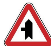
B9a—Entroncamento com via sem prioridade
