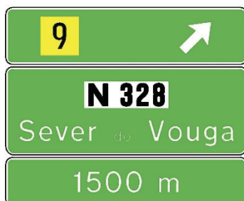
I1-Pré-aviso simplificado (Interseção desnívelada)
