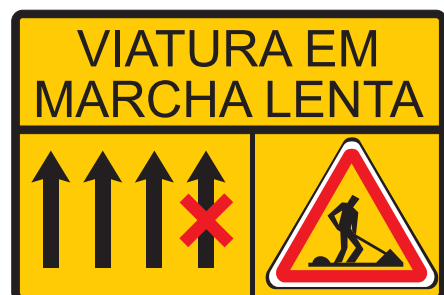
TC 11 — Painel indicativo de circulação de viatura em marcha lenta (4 vias) Dim = 2,33 x 2,10 m
