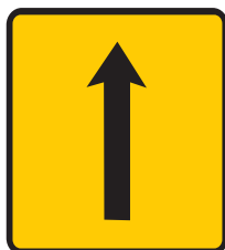
TC 1 — Painel indicativo da circulação — 1 via na direcção da circulação Dim = 0,90 x 0,90 m
