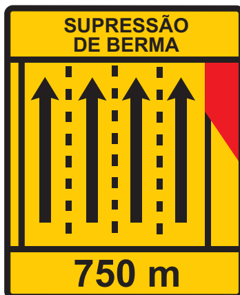
TC 12 — Painel indicativo de supressão de berma (4 vias) Dim = 1,85 x 2,90 m
