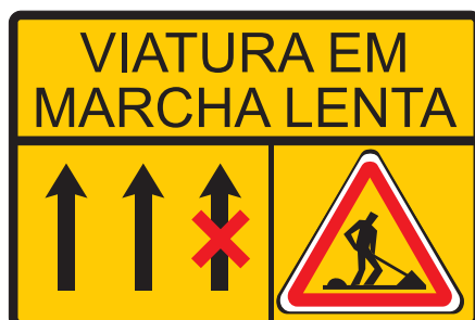
TC 10 — Painel indicativo de circulação de viatura em marcha lenta (3 vias) Dim = 2,33 x 2,10 m
