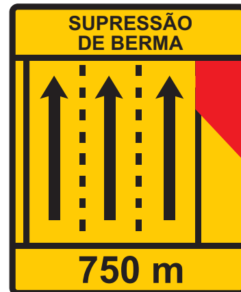
TC 8 — Painel indicativo de supressão de berma (3 vias) Dim = 1,85 x 2,90 m
