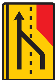
TD 1 — Painel de estrangulamento à direita (2 vias) — Desvio da via direita para a via esquerda Dim. = 1,20 x 2,20 m
