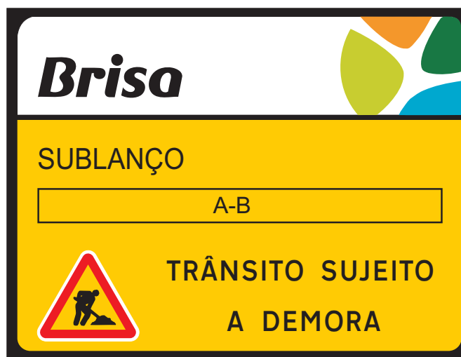
TV 2 — Trânsito sujeito a demora A = Nó início do sublanço B = Nó fim do sublanço Dim. = 2,30 x 1,75 m
