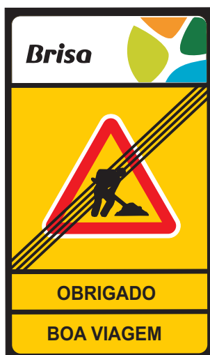
TV 1 — Fim de trabalhos Dim. = 1,60 x 2,70 m
