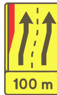
TD 31 — Painel de estreitamento à esquerda (1x4) Dim = 1,025 x 1,735 m
