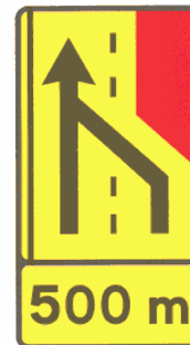
TD 19 — Painel de estrangulamento à direita (1x4) — Desvio da via direita para a via esquerda Dim = 0,925 x 1,735 m
