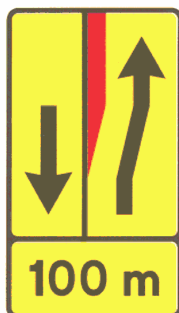
TD 23 — Painel de estreitamento à esquerda (1x2) Dim = 0,975 x 1,735 m
