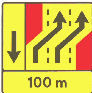
TD 29 — Painel de desvio de direção (1x4) Desvio de duas vias para as duas vias adjacentes à direita Dim = 1,725 x 1,735 m
