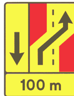
TD 25 — Painel de desvio de direção (1x2+VL ou 1x4) — Desvio de uma via para a via adjacente à direita Dim = 1,30 x 1,735 m
