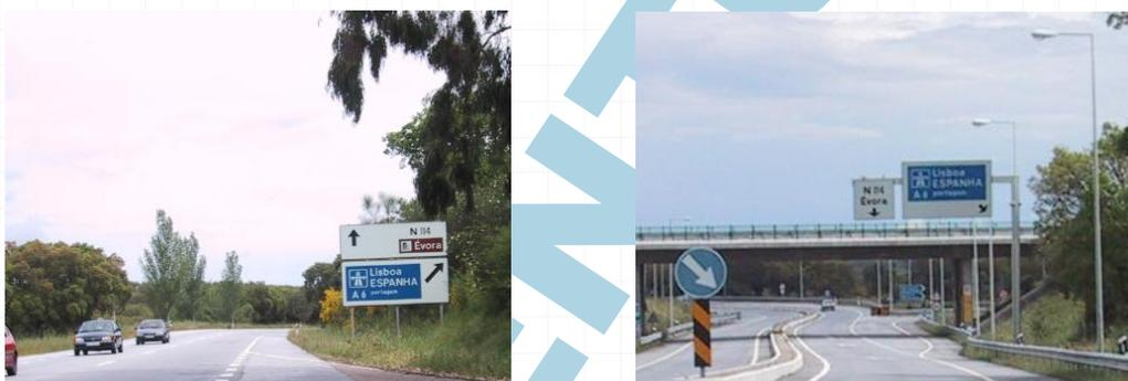
**Figura 2. 3** - Pré-sinalização de uma intersecção desnivelada
