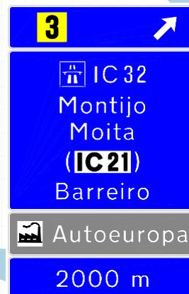
Figura 3. 6 - Pré-aviso simplificado com bloco
