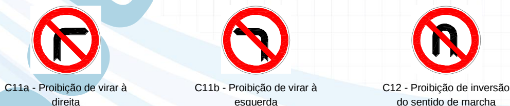
Figura 4. 5 - Sinais de proibição que podem ser colocados a uma distância conveniente do local onde a proibição é imposta
