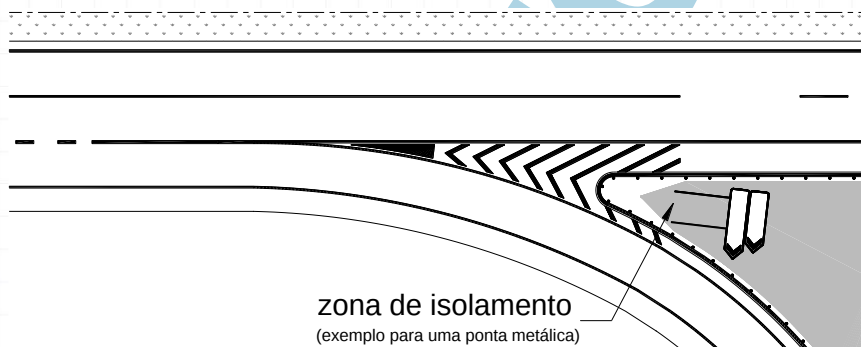
Figura 4. 48 - Colocação longitudinal de setas de direcção em intersecções desniveladas
