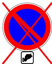
**Figura 15. 24** - Exemplo de utilização incorrecta do painel adicional do modelo 20
