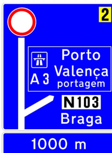
Figura 4. 9 - Exemplo de pré-aviso gráfico com sinal C2
